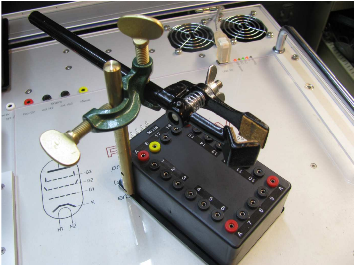
Universelle Nixie-Prüfbox (A=Anode E= Erde/Masse 1...17=Kathode)
